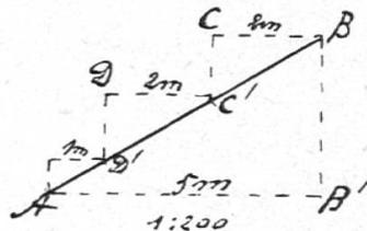
Die Länge der Böschungsfläche betrage 63 m; dann ist der Inhalt des Grundrisses  $= 63 \cdot 5 \text{ m}^2 = 315 \text{ m}^2$  und der Nutzungswert  $= 63 \text{ Fr}$ .
