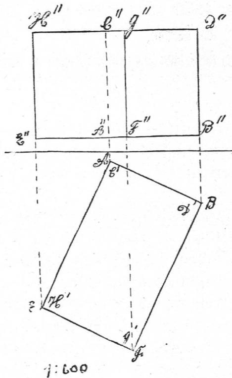
*Verallgemeinerung.* Wie haben wir in diesen Fällen den Grundriss und den Aufriss entstehen lassen? Was für einen Grundriss hatten Kanten und Flächen, welche parallel zur Grundrissebene lagen, solche, die zu ihr senkrecht waren? Was für einen Aufriss hatten solche Kanten und Flächen? Welche Kanten und welche Flächen haben sich in wahrer Grösse projiziert? (solche, die parallel zur Projektionsebene liefen). Welche erschienen in der Projektion verkürzt? (solche, die schief zur
