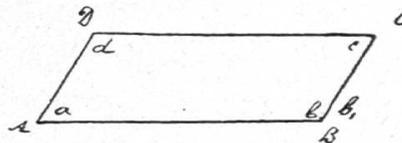
Es sei  $AB \parallel DC$ ,  $AD \parallel BC$ ,  $ABCD$  also ein Parallelogramm.  $W. a = W. b_1$  als korrespondierende Winkel an der Transversalen  $AB$  zwischen den Parallelen  $AD$  und  $BC$ .  $W. c = W. b_1$  als Wechselwinkel an der Transversalen  $BC$  zwischen den Parallelen  $AB$  und  $DC$ , folglich:  $W. a = W. c$ .
