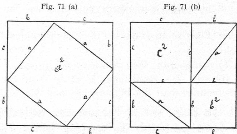
In das Quadrat Fig. 71 a legen wir das rechtwinklige Dreieck  $A B C$  viermal ein; dann entsteht in der Mitte ein gleichseitiges Viereck, dessen Seite die Hypotenuse  $a$  unseres rechtw. Dreiecks ist. Jeder seiner Winkel wird durch die Dreieckswinkel  $\beta$  und  $\gamma$  zu  $180^\circ$  ergänzt; da letztere zusammen  $90^\circ$  betragen, sind die Winkel dieses Vierecks rechte; letzteres ist also
