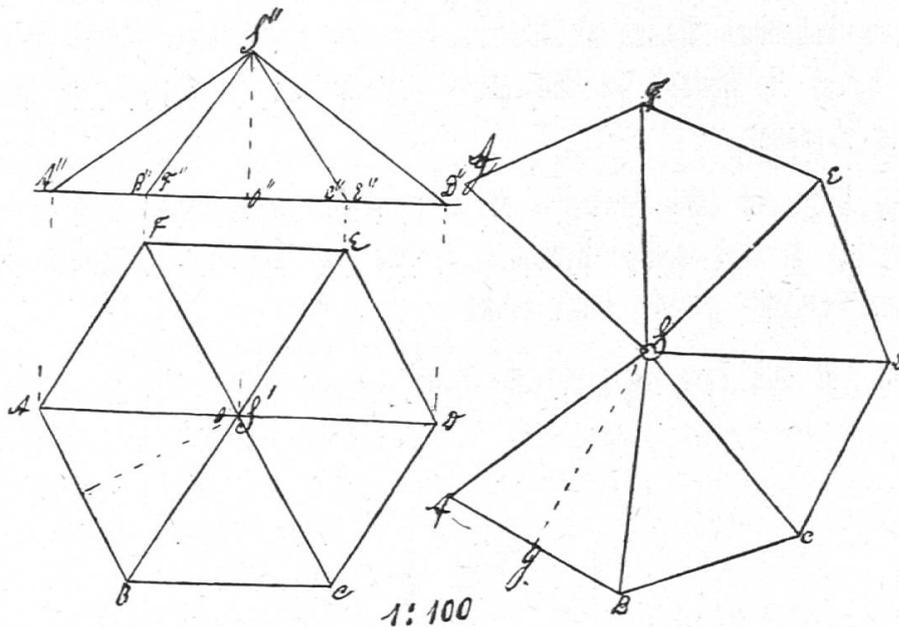
$AB = 2$  m,  $AS = 2,5$  m,  $SG$  (Höhe einer Seitenfläche)  $= 2,3$  m, Höhe eines Dreiecks der Grundfläche  $= 1,7$  m.
