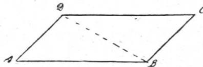
Sie teilt das Parallelogramm  $A B C D$  in die 2 Dreiecke  $A D B$  und  $B C D$ , deren Kongruenz wir beweisen können:  $B D$  haben sie gemeinsam;  $\sphericalangle A B D = \sphericalangle B D C$  als Wechselw. an der Transversalen  $B D$  zwischen den Parallelen  $A B$  und  $D C$ ;  $\sphericalangle A D B = \sphericalangle D B C$  als Wechselw. an der Transversalen  $B D$  zwischen den Parallelen  $A D$  und  $B C$ .
