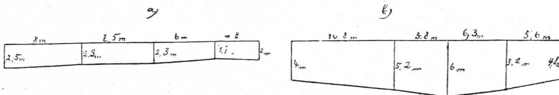
3) Berechne die Kosten für den Aushub eines Grabens von folgenden Ausdehnungen: seine Breite beträgt durchwegs 80 cm; seine Länge misst 200 m. Zu unterst ist er 1,5 m tief; seine Tiefe beträgt Ende des 10. Längensmeter 1,2 m, Ende des 35. 1,4 m, Ende des 60. 1,80 m, Ende des 75. 1,5 m; er behält diese Tiefe bei bis Ende des 160. Meter; Ende des 185. Meter ist die Tiefe 1,7 m und Ende des 200. 1,5 m. Man zahlt 90 Rp. pro  $m^3$ . Zeichne Grund- und Aufriss des Grabens.
