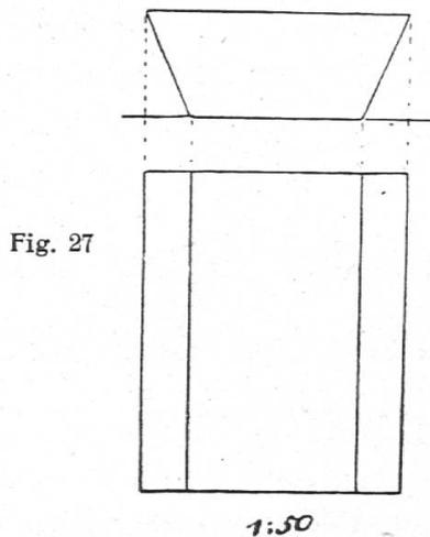
Sehen wir eines der Trapeze als Grundfläche an, so hat der Trog die Gestalt eines senkrechten Prismas. Sein Inhalt = Trapez  $\times$  Länge =  $\frac{0,8 + 1,2}{2} \cdot 0,5 \cdot 1,5 \text{ m}^3 = 0,75 \text{ m}^3$ .
