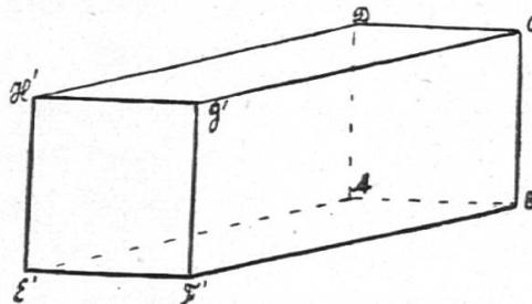
*Bezeichnung.* Die Punkte A, B, C, D sind Originalpunkte. E', F', G', H' sind Schattenpunkte oder Projektionen der vorderen Modellpunkte E, F, G, H. Das deuten wir durch Striche an.
