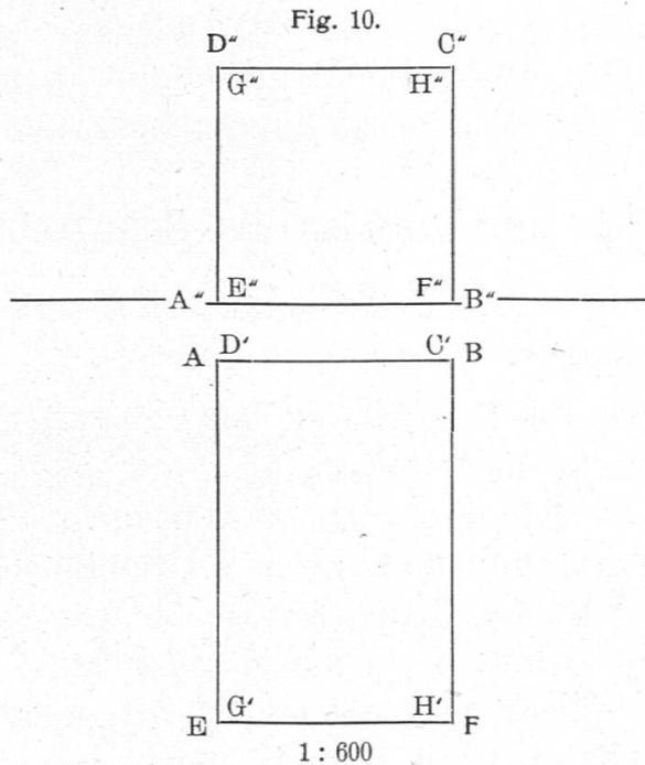
Wir wollen nun die Aufrissebene nicht abtrennen, sondern um die Linie, nach welcher sie die Grundrissebene schneidet, in die Grundrissebene umdrehen. Diese Schnittlinie nennen wir die *Achse*. Wie liegen Grund- und Aufriss eines Eckpunktes hinsichtlich der Achse?  $G''$  (Aufriss von  $G$ ) liegt senkrecht über  $G'$  (Grundriss von  $G$ ).
