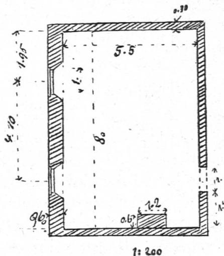
Grundriss. hätte. Um einen brauchbaren Plan zu bekommen, denken wir uns durch das Zimmer einen wagerechten Schnitt etwa 1 m 50 cm über dem Boden geführt und zeichnen die Figur, welche die Ebene herausschneidet. Sie heisst ein vollständiger Grundriss des Zimmers. Nimm die nötigen Dimensionen, und zeichne diesen Grundriss. Es kommen hier die Fenster und die Thüre hinzu. Der Grundriss des Fensters besteht aus einem symmetrischen Trapez und aus zwei kleinen Rechtecken (Fig. 2).
