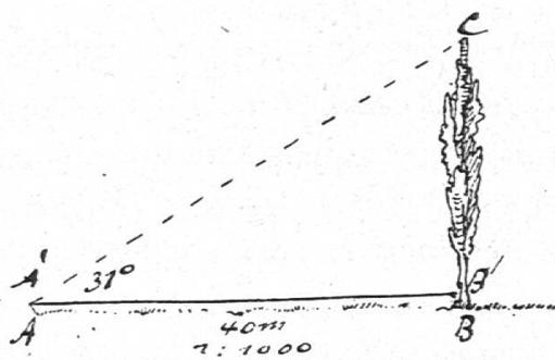
In welcher Beziehung stehen das Dreieck  $A B C$  in der Zeichnung und dasjenige in der Natur? Jede Seite des Bild-dreiecks ist  $\frac{1}{1000}$  von der entsprechenden Seite des Original-dreiecks; ihre Winkel sind paarweise gleich. Wie bezeichnet man diese Beziehung?
