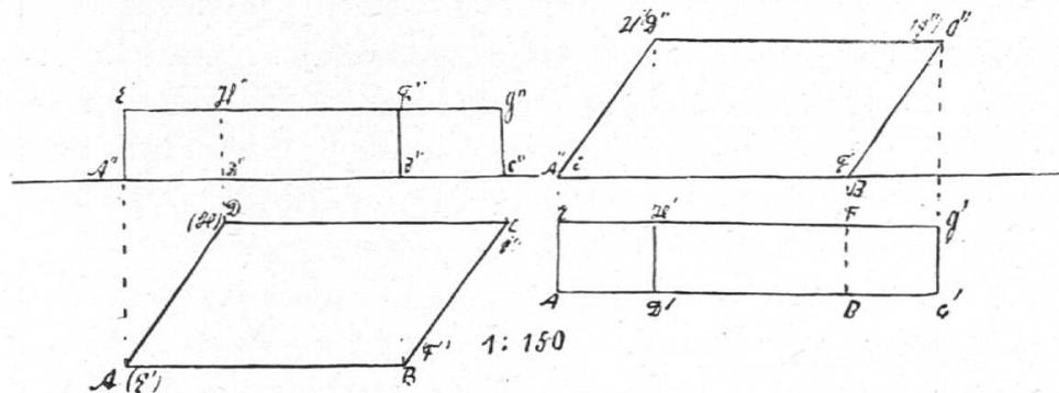
Fig. a geht in Fig. b über, wenn wir die Aufrissebene mit der Grundrissebene vertauschen.
