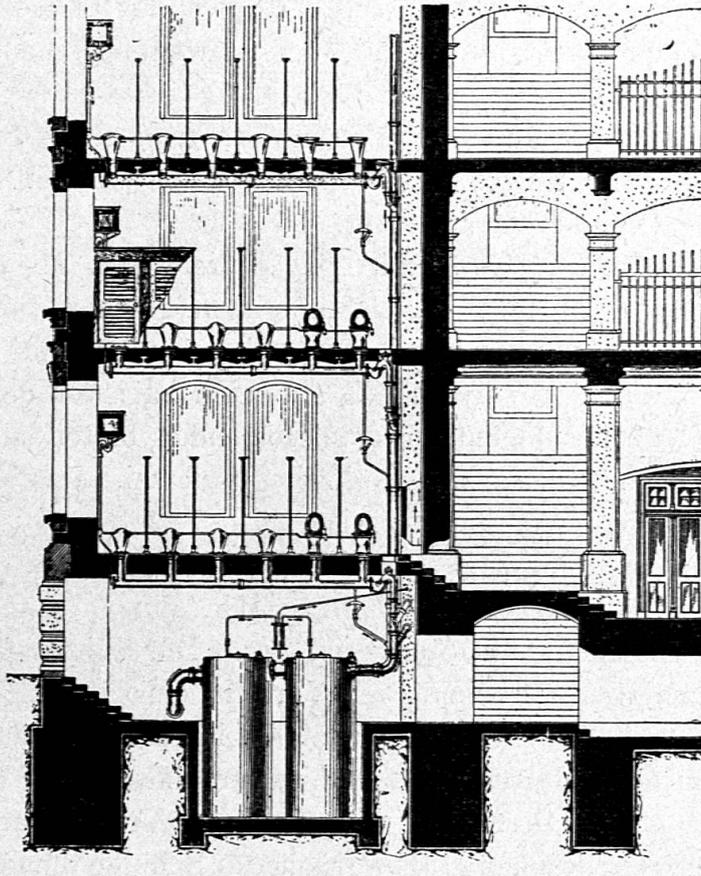
Zentralklosettanlage mit Kläranlage der Firma Lehmann & Co.
