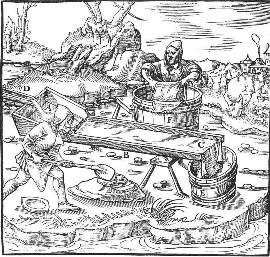
Der Sand wird hier über ein rauhes Tuch oder Fell geschwemmt; der Goldschlich fängt sich in den Fasern oder Haaren. Tuch oder Fell werden im Bottich (hinten) ausgewaschen, aus dem schließlich der Goldschlich gesammelt wird.
