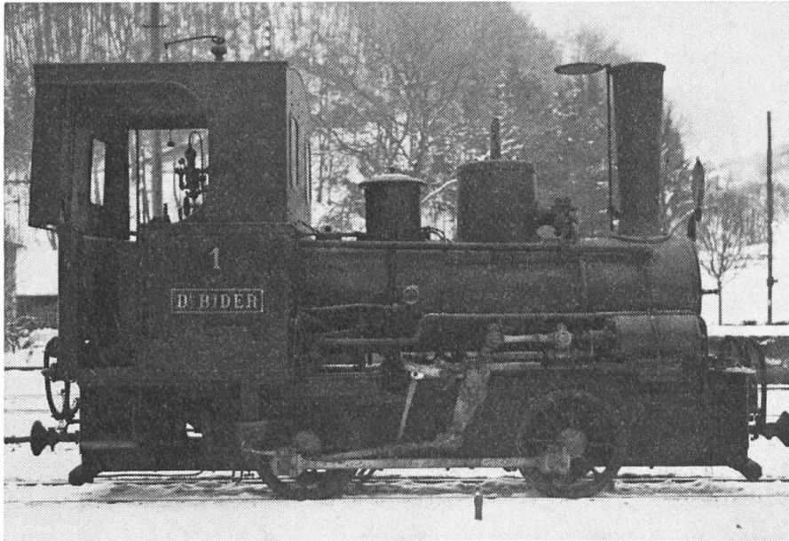
Die erste, nach dem Mitbegründer der WB benannte Lok Dr. Bider, Typ G 2/2, Gewicht 8 t, Höchstgeschwindigkeit 25 km/h, Zugkraft 920 kg.
