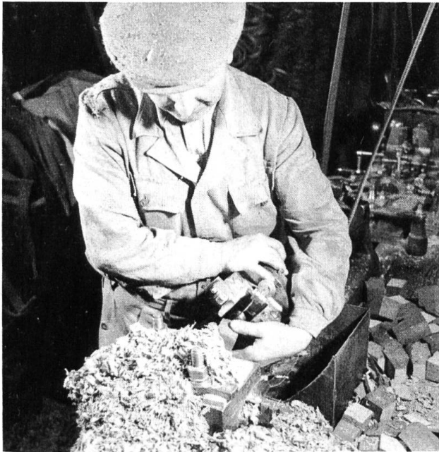
Fabrikation der Appenzeller Pfeife bei Max Tschan & Cie: Andrehen des Holzes.
