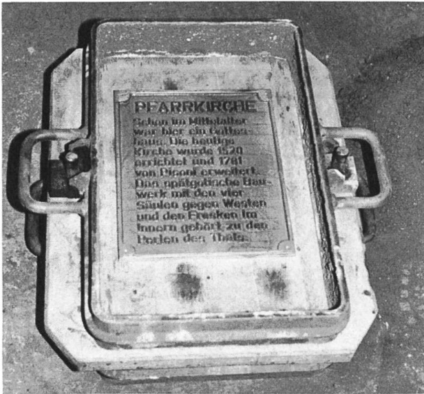
Der Balsthaler Kunstgiesser Urs Hafner hat das Holzmodell der Bronzetafel in einen Rahmen gelegt.
