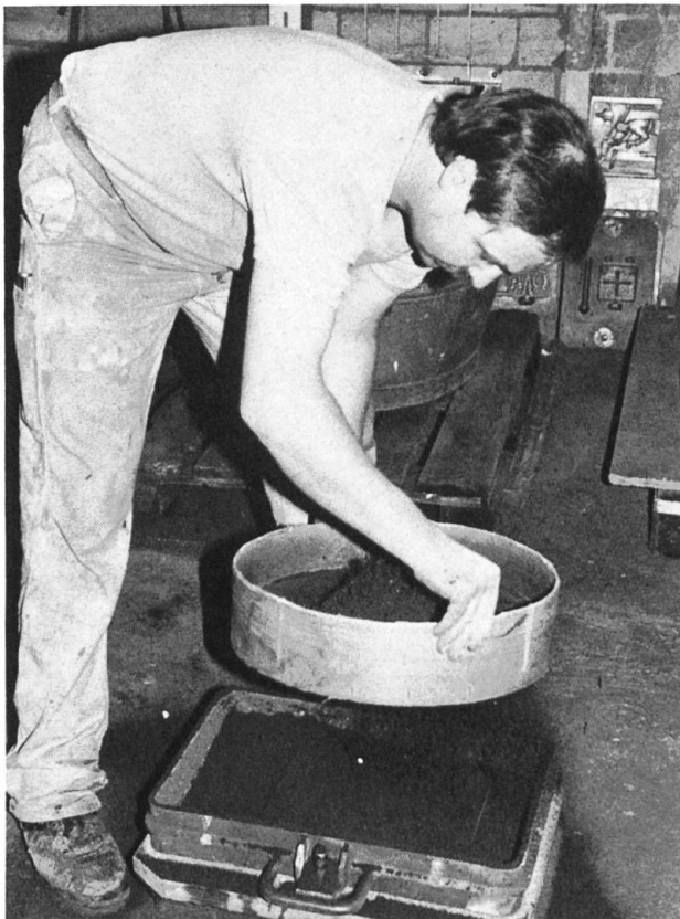
Der Giesser sibt den Formsand über das Holzmodell in den Rahmen.
