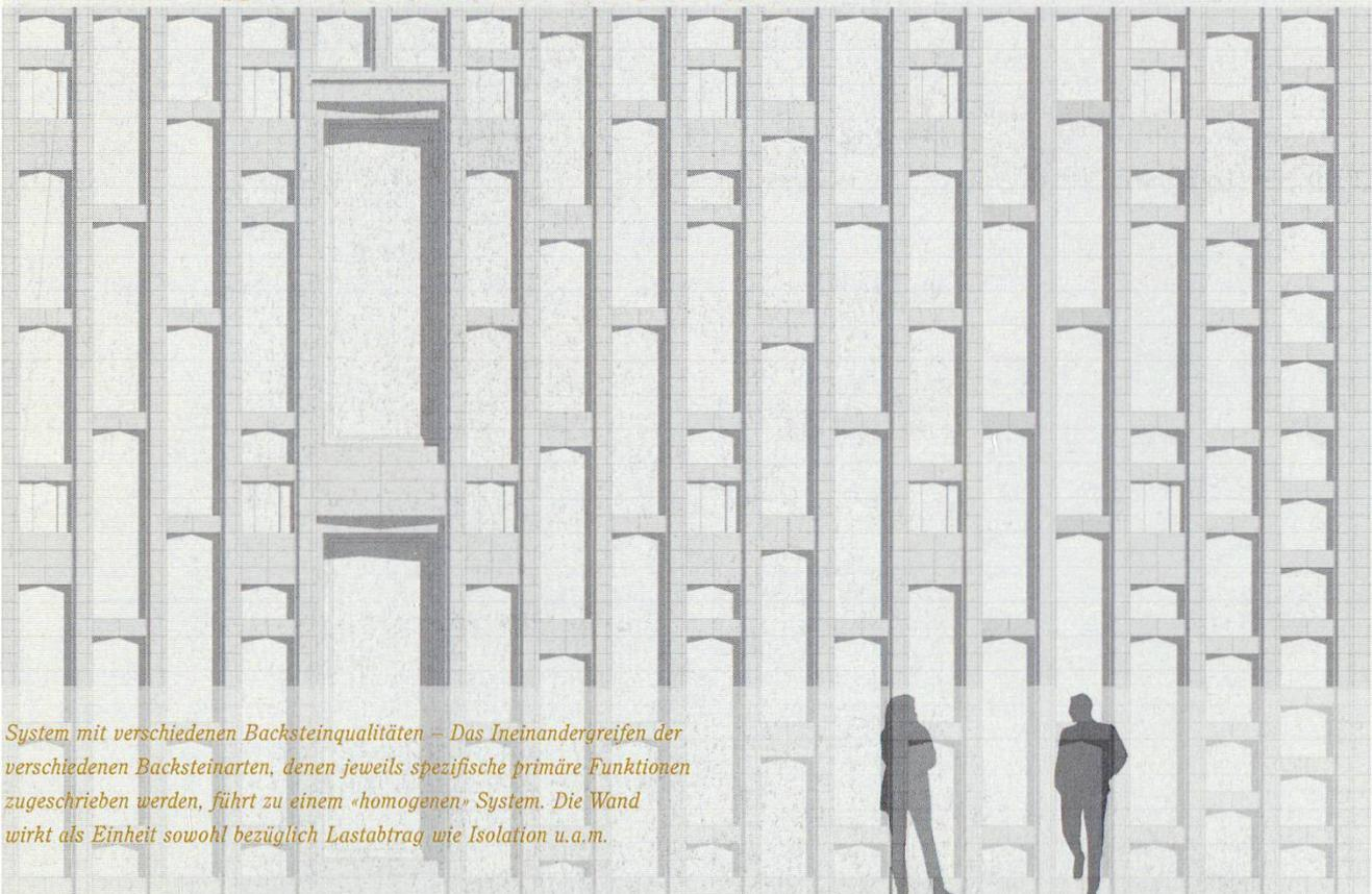
System mit verschiedenen Backsteinqualitäten – Das Ineinandergreifen der verschiedenen Backsteinarten, denen jeweils spezifische primäre Funktionen zugeschrieben werden, führt zu einem «homogenen» System. Die Wand wirkt als Einheit sowohl bezüglich Lastabtrag wie Isolation u.a.m.
