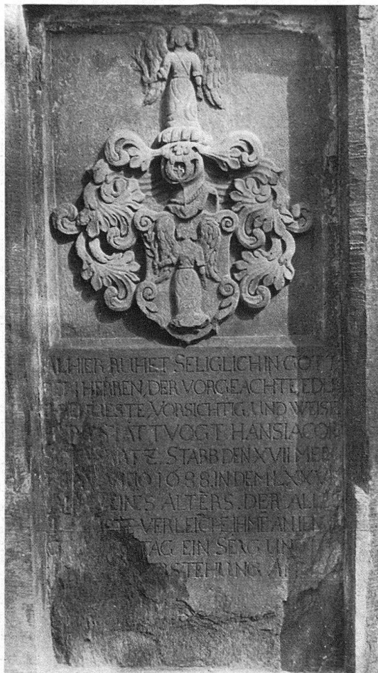
Links: Grabtafel Nr. 48 (vom Eingang gezählt) aus Scalärastein im Scalettafriedhof in Chur, datiert 1688. Aufnahme 1936, bereits erhebliche Schäden zeigend. Die Einfassung im Grundfeuchtebereich ist in Zementmörtel erneuert. Rechts: Aufnahme der gleichen Tafel im Herbst 1966. Große Ausdehnung der Zerstörung, auch oben. Die Einfassung in Mörtel ergab keinen Schutz
