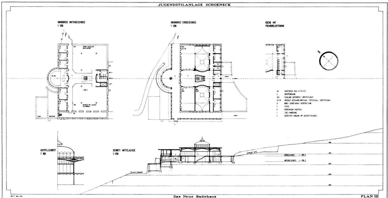
Umbauvorschlag für das neue Badehaus, dessen leichte Stahlkonstruktion im Innern sich für die flexiblen und z. T. grossflächigen Versammlungs-, Schulungs- und Therapieräume eignet, denen die Lichtführung durch die Kuppel zugute kommt.
