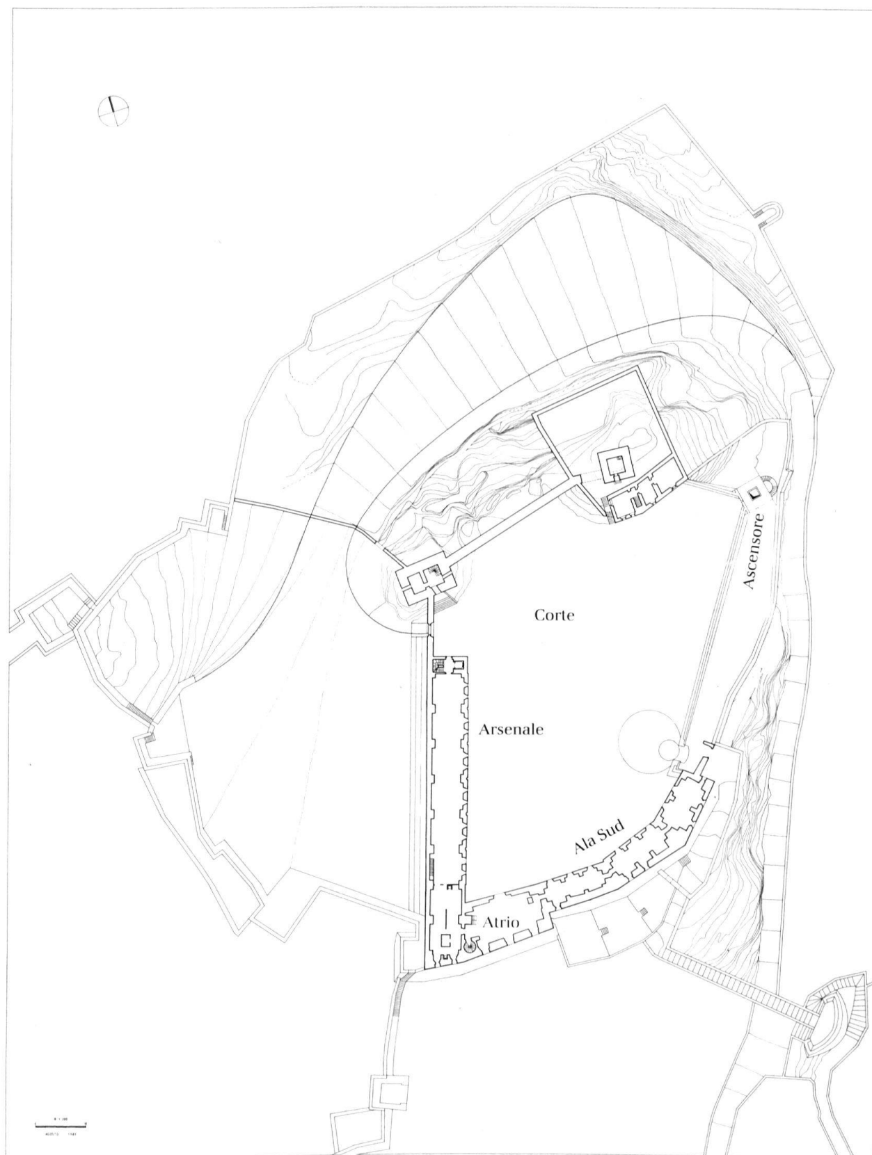
1 Pianta di Castelgrande. La torre al centro snoda tre settori distinti che assumono un trattamento differenziato del suolo teso a evidenziare il raccordo dei manufatti con il terreno. La ricca orografia dell'intorno naturale (evidenziata dalle curve di livello) sottolinea i piani e le superfici «disegnate» come parti del progetto.
