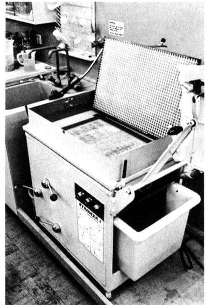
4 Laborbetrieb einer Chlordioxidgasanlage nach Dr. Rey. Wasserempfindliche kolorierte Papiere können mit diesem Gas so behandelt werden, dass Holzschliffpapieren das schädliche Lignin entzogen wird. Das giftige und explosive Gas kann nach diesem System völlig gefahrlos gehandhabt werden. Die Anlage ist heute im Schweizerischen Bundesarchiv fest installiert.
