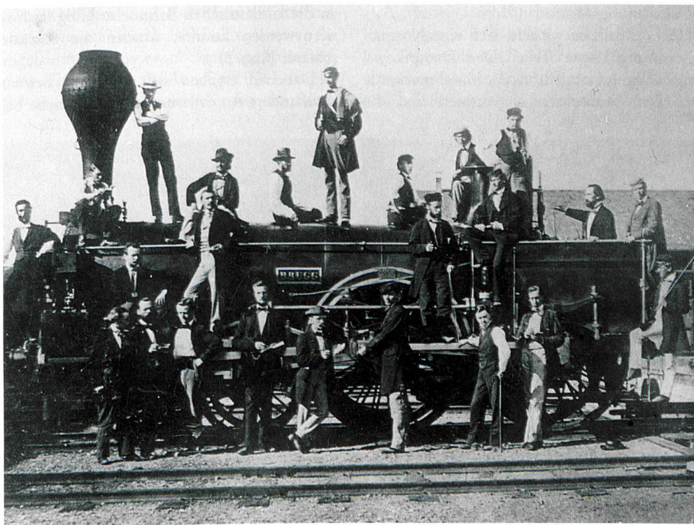
1 Schnellzug-Schleptender-Lokomotive, Bauart 2B, Nr. 15 «BRUGG» der Schweizerischen Nordostbahngesellschaft NOB, hergestellt von «J. A. Maffei» in München 1856, Aufnahme mit Studenten des Polytechnikums unter der Leitung von Prof. Releux, vermutlich kurz nach der Ablieferung der Lokomotive im Juni 1856, Fotograf(in) unbekannt. – Typisch für die ersten Lokomotiven in der Schweiz waren der Funkenfänger im Kamin wegen der Holzfeuerung und der völlig ungeschützte Arbeitsplatz des Personals.
