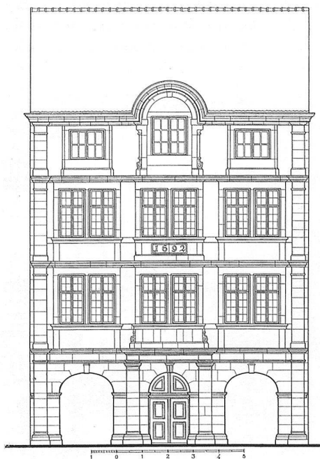
11 Neuchâtel, maison Tribolet, rue des Moulins n° 31, 1692. – La façade reproduit la structure typique de la maison du chancelier Montmollin, mais avec des pilastres en place de colonnes de part et d'autre de l'entrée.
