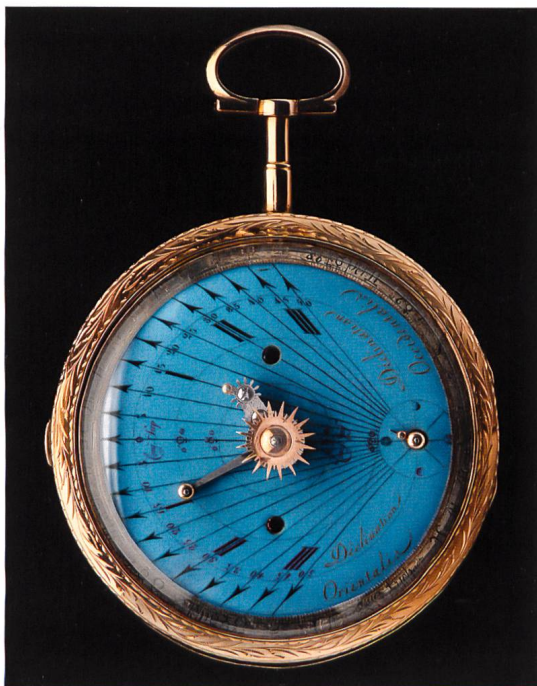
Astronomische Taschenuhr von Jakob Auch, um 1790. Das blaue Zifferblatt dreht sich um die Sonne im Zentrum und stellt die Bewegung der Erde um die Sonne dar, um die Erde kreist der Mond, um die Sonne die Planeten Merkur und Venus. Durchmesser: ca. 60mm. © Uhrenmuseum Beyer, Zürich
