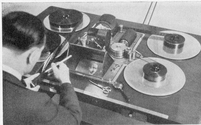
Tonschneidetisch. — Arbeitsvorgang: Synchronanlagen eines getrennten Bild- und Tonbandes. Turicia-Film A.G.
