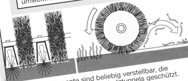
Die Bürstenelemente sind beliebig verstellbar, die Pflanzen werden durch die Schutztunnels geschützt.
