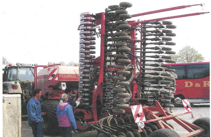
Sämaschine im EU-Format mit neun Meter Arbeitsbreite.
