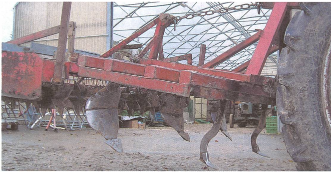
Mit diesem relativ einfachen Gerät wird gelockert und werden die Dämme geformt.
