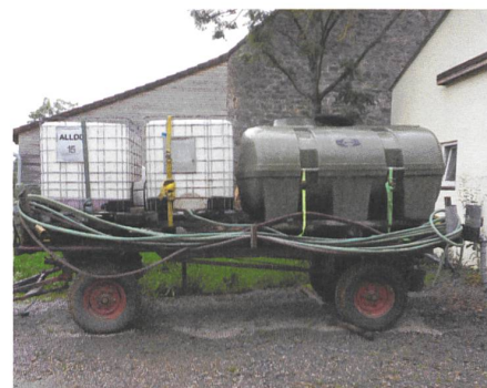
Zwei gebrauchte 1m 3 -Behälter und ein neuer 3m 3 -Behälter sind auf dem Anhänger gut befestigt und bieten mehrere Wasserentnahmemöglichkeiten.
