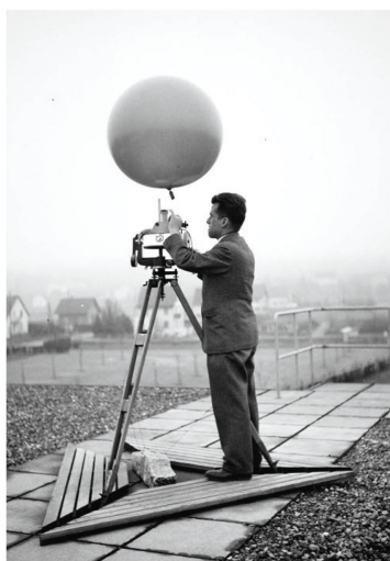
Durant les années 1930 et 1940, les vents d'altitude étaient mesurés à l'aide d'un ballon comme celui-ci.
