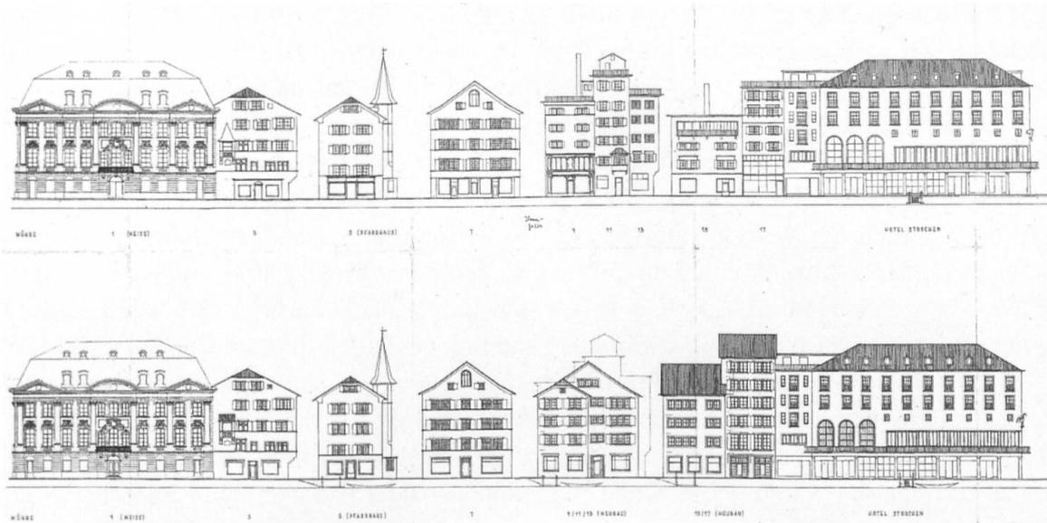
Abb. 88: Walther Niehus, Sanierungsprojekt für die Altstadt, Block 31 (1950). Fassaden an der Wühre, Bestand (oben) und Projekt (unten).
