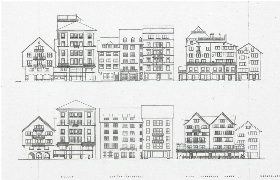
Abb. 73: Viktor Nussbaumer, Theodor E. Laubi, Sanierungsprojekt für die Altstadt, Block 19 (1948). Fassaden an der Schiffflände, Bestand (oben) und Projekt (unten).
