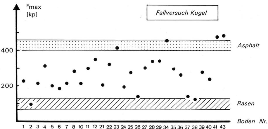
Abbildung 5: Maximale Kraftamplituden auf verschiedenen Kunststoffbelägen bei einem Fallversuch mit einer Eisenkugel ( $m = 2,1$  kg) aus der Höhe von 16 cm ( $\Delta F = 5$  Prozent) nach Denoth (1978).
