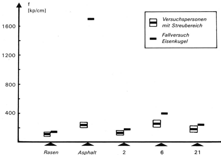
Abbildung 6: Vergleich der «Federkonstanten» auf verschiedenen Bodenbelägen bei einem vertikalen Standsprung mit Landung auf der Ferse (zwei Versuchspersonen) und einem Fallversuch ( $m = 2,1 \text{ kg}$ ) nach Denoth (1978).
