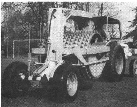
Aerifiziergerät mit motorisch angetriebenen Werkzeugen
