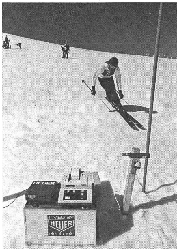
Arrivée à 3500 m d'altitude: cellule photoélectrique et imprimante de temps Centigraph HL 305.
