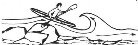
ce sont des mouvements d'eaux horizontaux, en surface, provoqués par un cisaillement entre un courant rapide franchissant un seuil et la zone plus calme derrière celui-ci. Selon la hauteur du rouleau, mieux vaut l'éviter ou alors le franchir avec beaucoup de vitesse et à angle droit.
