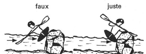
stacle qu'il s'agit de contourner pour repartir. Ce système permet d'éviter que le courant ne monte sur le pont, ce qui aurait pour effet de faire chavirer et d'enfoncer l'embarcation. Celle-ci pourrait alors se casser en deux.
