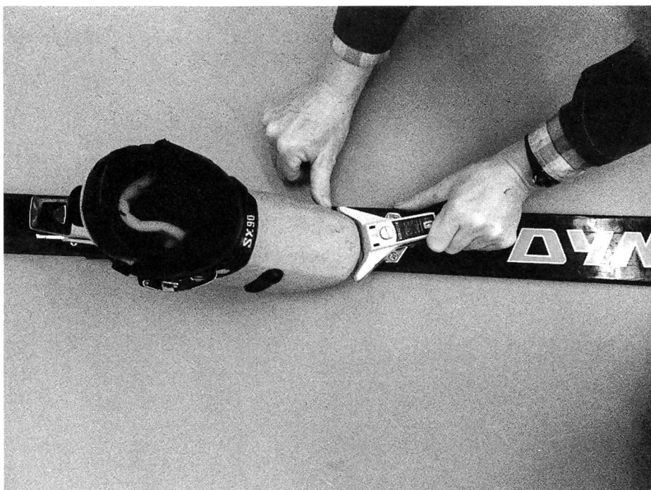
Contrôle de l'élasticité latérale.
