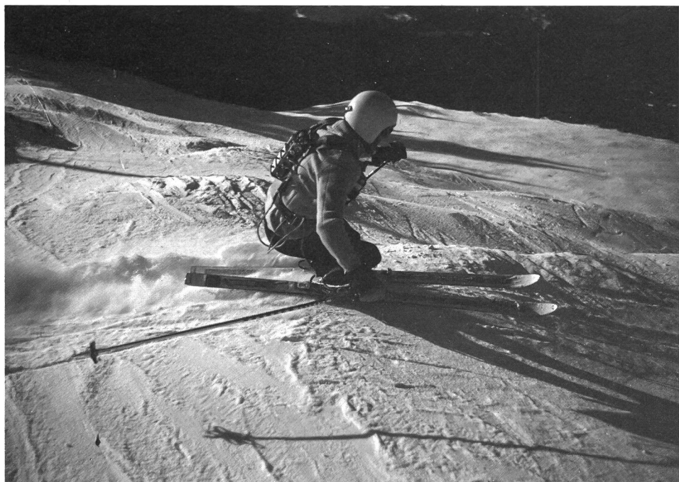
Le ricerche in vista di migliorare la concezione degli sci passano ora tramite l'identificazione precisa del loro lavoro sulla neve. Perciò vengono equipaggiati di fettucce estensometriche (misura delle deformazioni superficiali) o di accelerometri (misura degli choc) i cui segnali sono registrati su nastro magnetico. Nella foto, il collaudatore porta il registratore sul petto e sulla schiena l'alimentatore e gli amplificatori.
