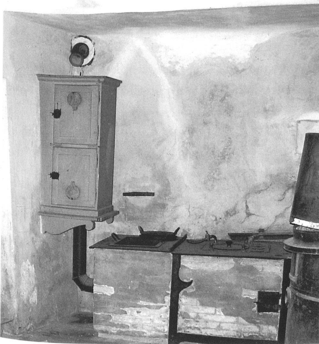
10: Schloss Reichenau. V.r.n.l.: Wasserbad mit der Feuerung seitlich rechts; Sandbad; zwei Trockenschränke, darüber der Eintritt des Abluftrohres in den Kamin. Höhe der Arbeitsflächen 71 cm.
