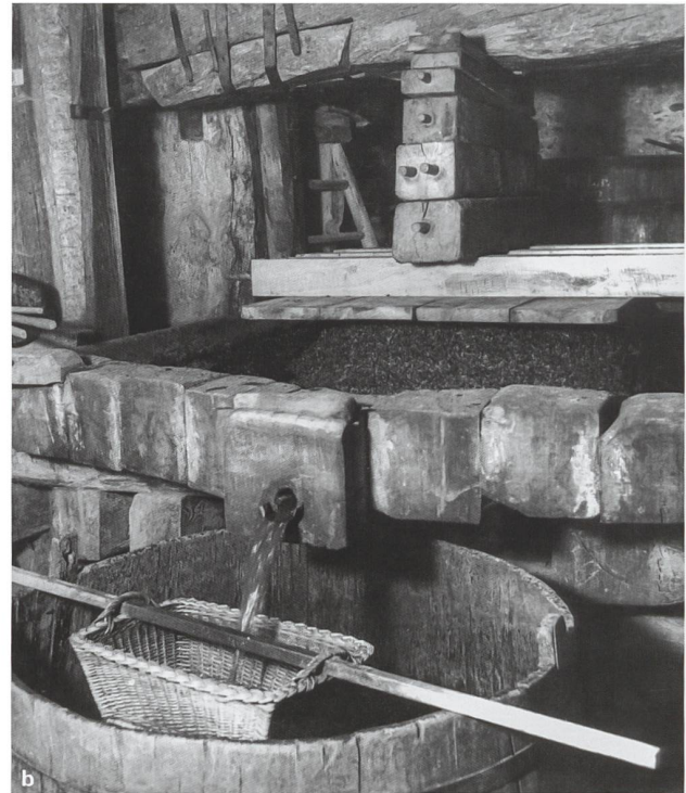
21: Chur, Katztorkel. Durch Drehung der geölten Spindel a wird der Gewichtsstein angehoben und der Torkelbaum presst den Saft aus dem im Pressbett aufgeschichteten Trester b (Aufnahme um 1950).
