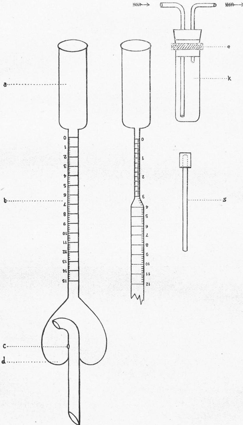
scharfe Trennung der beiden Flüssigkeiten statt. Das über dem Wasser befindliche Xylol (Petrol etc.) fliesst durch die Oeffnung bei *c* grösstenteils wieder in den Kolben zurück, was zur Folge hat, dass wesentlich weniger dieser Destillierflüssigkeit verwendet werden muss, als bei dem gewöhnlichen Destillierverfahren. Durch die Einkerbung bei *d* wird ein zu starkes
