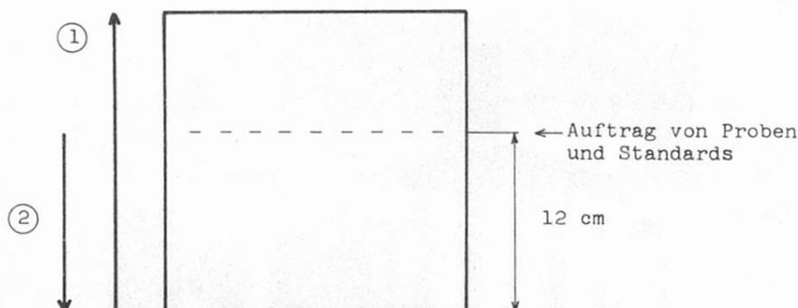
Abb. 2. Auftrags- und Entwicklungsschema für die Dünnschichtchromatographie
