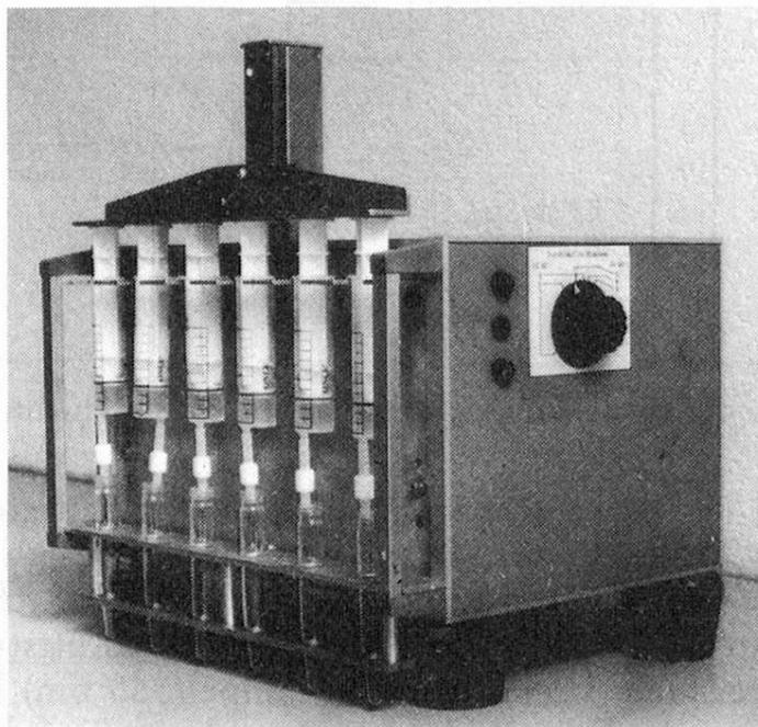
Abb. 1. Gerät zur gleichzeitigen Verwendung von 6 Sep-Pak-Kartuschen (Eigenkonstruktion)
