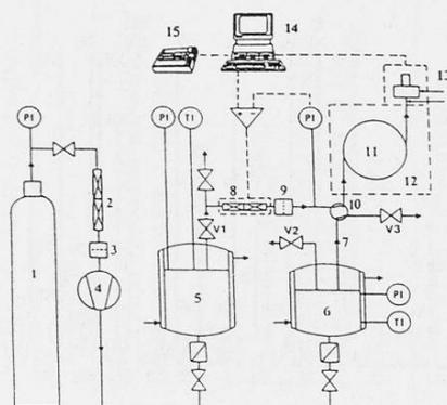
Fig. 5. Appareillage intégré permettant l'extraction surcritique (SFE) des arômes ( $\text{CO}_2$  à  $40^\circ\text{C}$  et 100 bar), leur injection directe (sans détente intermédiaire) et leur séparation chromatographique surcritique (SFC avec  $\text{CO}_2$ ) sur colonne capillaire
