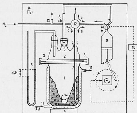
Fig. 3. Appareillage d'extraction des arômes par entraînement avec un gaz inerte ( $N_2$  à  $40\text{ }^\circ\text{C}$  et sous pression atmosphérique) avec récupération par un piège adsorbant (poudre de graphite ou charbon actif)
