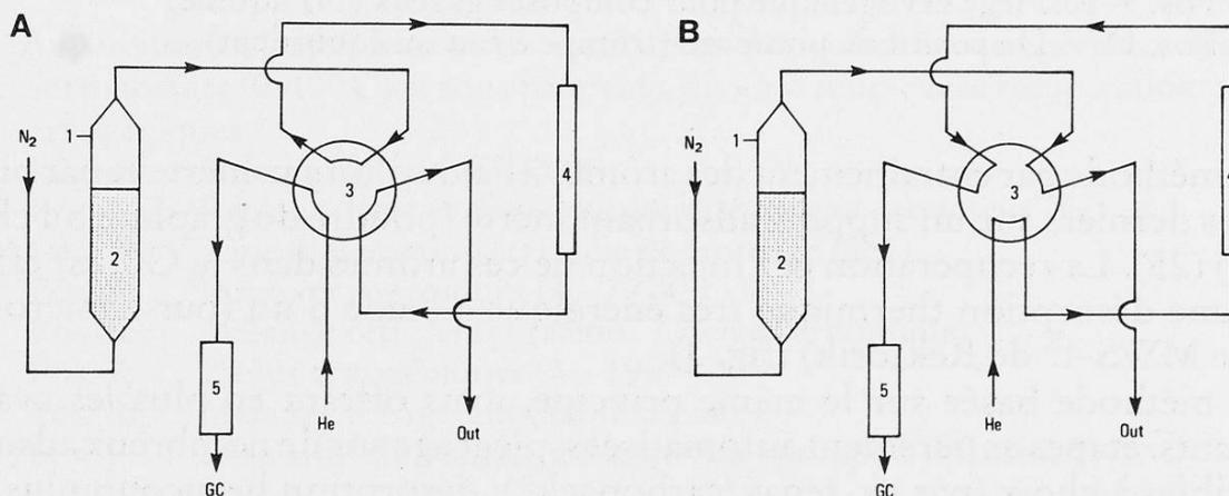
Fig. 4. Appareillage intégré permettant successivement: 1) l'extraction des arômes par entraînement avec un gaz inerte ( $N_2$  à  $40\text{ }^\circ\text{C}$  et sous pression atmosphérique) avec récupération par piège adsorbant (à choix), 2) la concentration et 3) l'injection des arômes dans un GC
