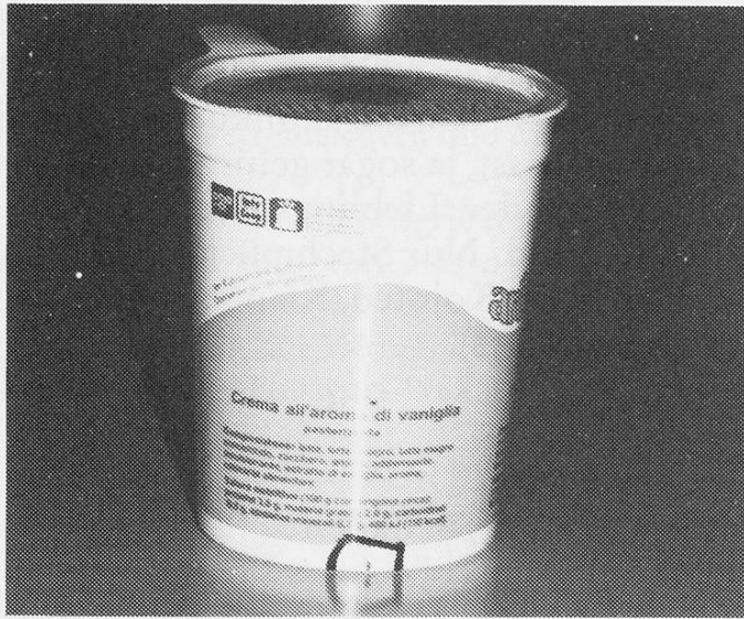
Abb. 2. Loch am unteren Rand eines Lebensmittel-Behlers. Als man immer an gleichen Stellen ein winzig kleines Loch fand, suchte man erfolglos nach einem vorstehenden Gegenstand in der Abfüllanlage. Für diese Löcher waren Hausmäuse verantwortlich (Exponat wie Abb. 1)
