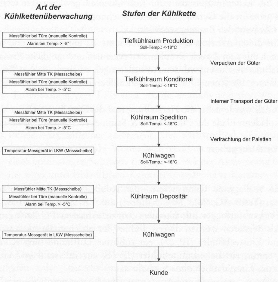
Abbildung 1 Überwachung und Stufen der Kühlkette in der Firma Kern & Sammet AG
