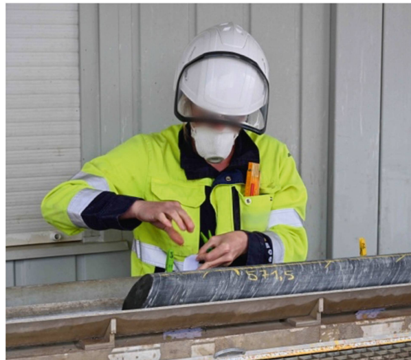
Abb. 8: Ein frisch erbohrter Gesteinskern wird vom Bohrturm abgeholt (links). Ein Bohrstellengeologe untersucht den Kern und wählt Proben für Laboruntersuchungen aus (rechts).
