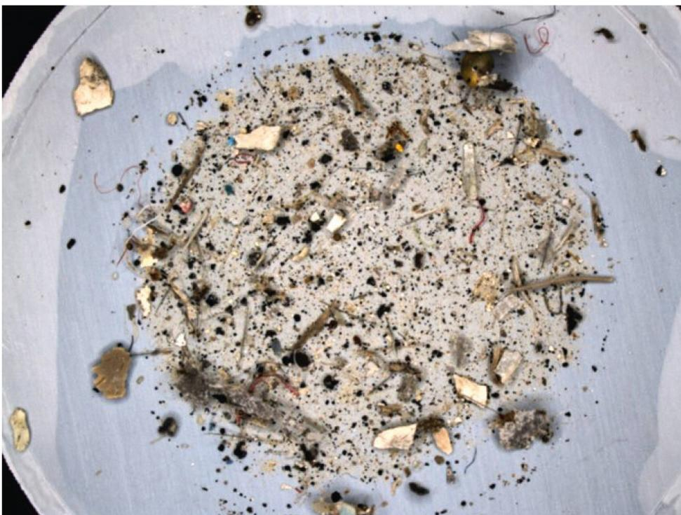
**Abb. 2:** Filter mit aus dem Boden extrahierten Mikroplastik. Die schwarzen Partikel stellen Reifenabrieb dar, die weissen und transparenten Partikel Bruchstücke von Verpackungsmaterial. Ausserdem sind deutlich rote Plastikfasern zu sehen. Neben Mikroplastik sind auf dem Filter auch noch Reste organischen Materials (Holz usw.). Das Mikroplastik in der Abbildung ist aus 5 g Boden extrahiert.
