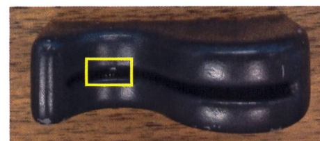
Dispositif de skimming saisi, avec lecteur de piste magnétique.
