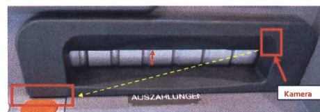
1 Dispositif de skimming avec mini camera et clé USB.
