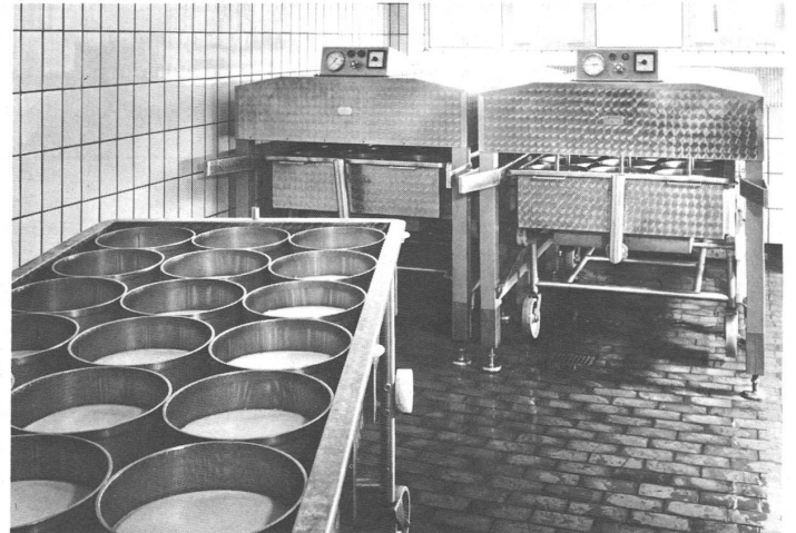
Compressori pneumatici pressano le forme di formaggio nelle loro forme perforate. Con questo procedimento non occorrono più tele; inoltre ci si limita a capovolgere due volte le forme.
