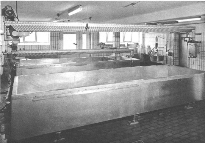
Caseificio appenzellese con due vasche, dalla capacità di 3500 litri l'una, aventi pareti interne in rame, per la fabbricazione del formaggio. Sul fondo, il nastro per il ricevimento e il trasporto del latte.
