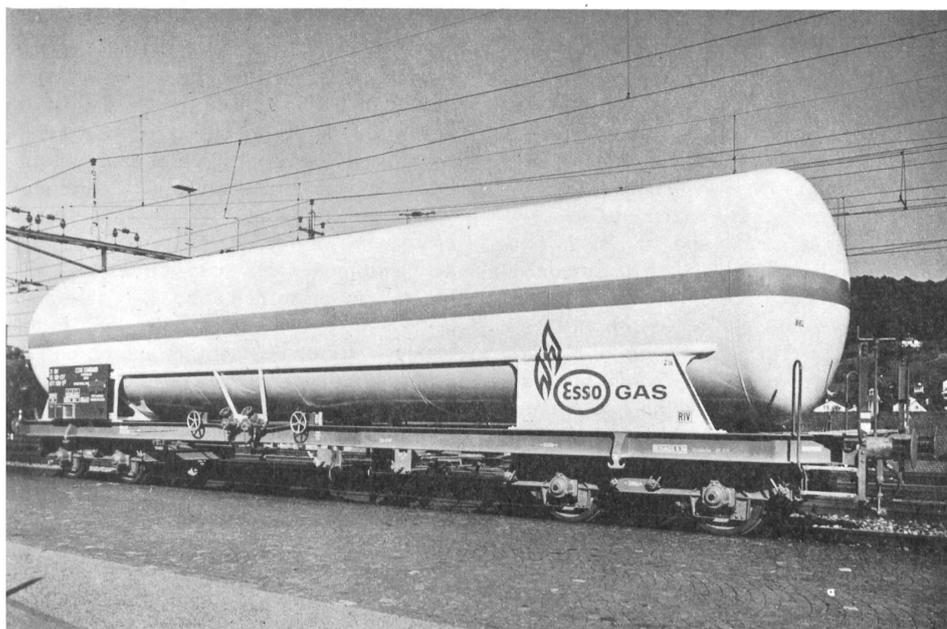
Carro cisterna gigante per il trasporto di gas liquidi (butagas e propagas). Ha una capienza di 105 m<sup>3</sup>, pari a 105.000 litri. Trasporta 46 t di butano e 44 t di propano. I gas liquidi si ottengono in raffineria e riuniscono i vantaggi dei combustibili liquidi e di quelli gassosi.
