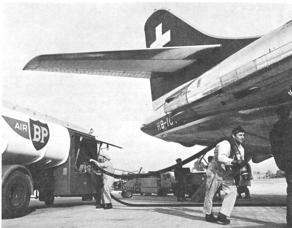
Aeroporto di Coltrin: rifornimento di carburante ad un aereo. L'aviazione è tra i più grandi consumatori di benzina. Per gli aerei a reazione viene impiegato il cherosene, miscela ottenuta mediante il processo di distillazione del petrolio.
