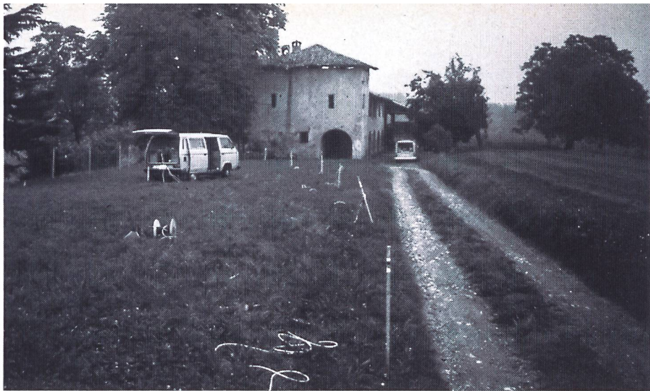
Dispositivi di misurazione dei segnali: in primo piano i cavi collegati ai geofoni, sullo sfondo la stazione mobile di registrazione del Politecnico federale di Zurigo. Valle della Motta.
