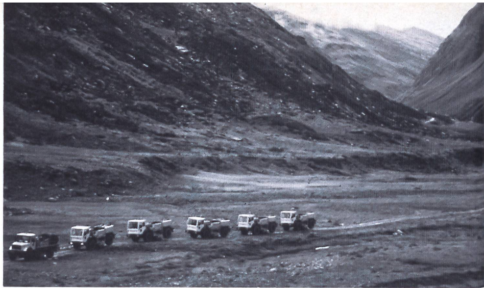
Potenti automezzi vibratori inviano un segnale nel sottosuolo delle Alpi. Campagna principale del PNR-20, Val Madris (GR). (Foto P. Heitzmann)
