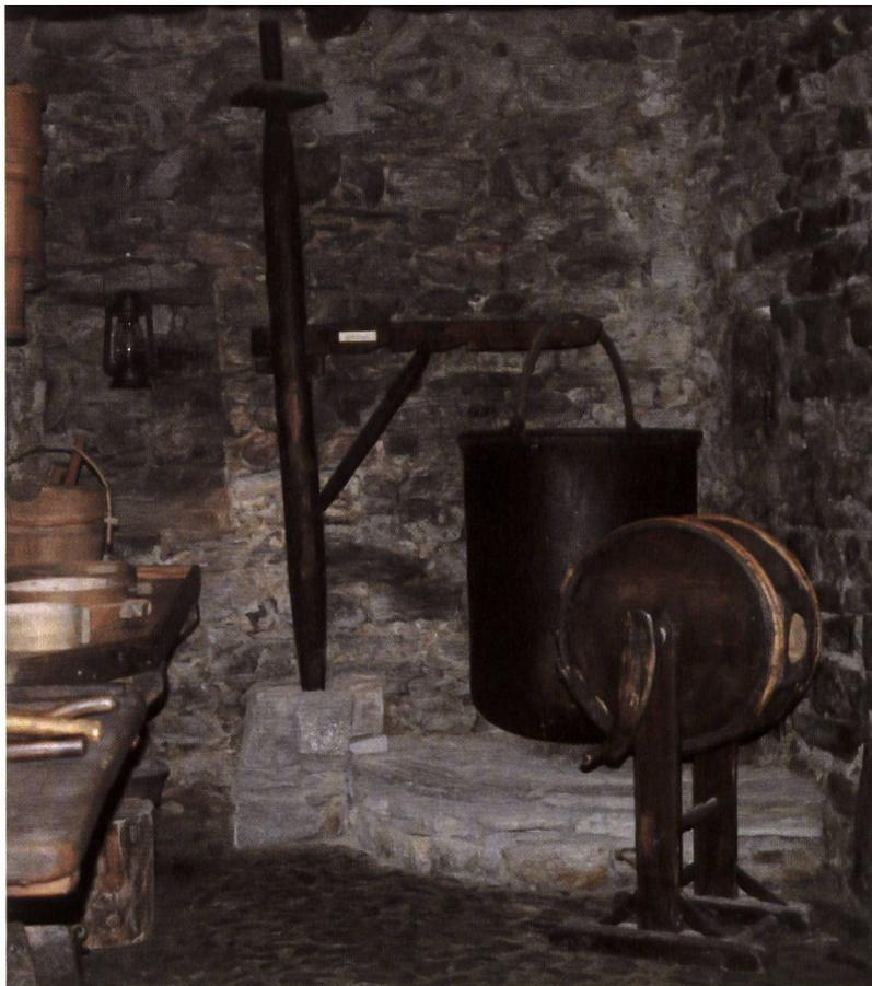
Casearia: sullo sfondo la «scigogna» (solido sostegno) per le capienti caldaie di rame usate per la fabbricazione del formaggio.
