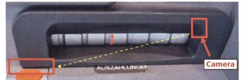
**1** Dispositivo di skimming con mini camera e chiavetta USB.
