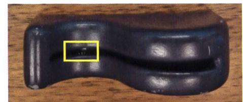
Dispositivo di skimming con lettore della banda magnetica.
