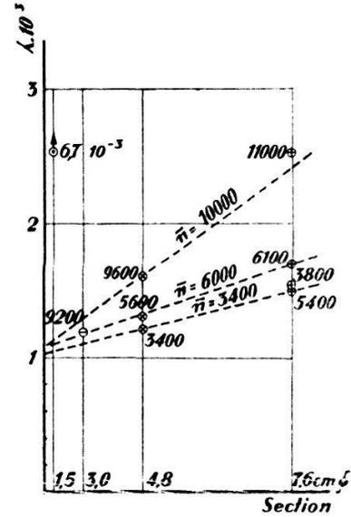
FIG. 34b. — Ions négatifs. Extrapolation par sections décroissantes.
