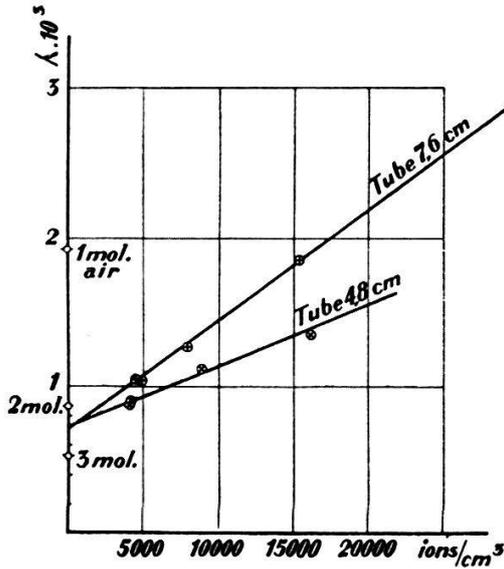
FIG. 33a. — Ions positifs. Extrapolation par densités décroissantes.
