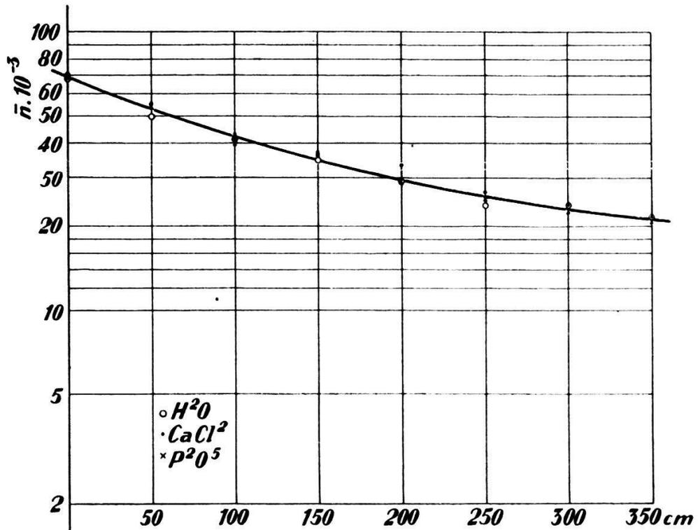
FIG. 28. — Affaiblissement d'un écoulement unipolaire positif.
