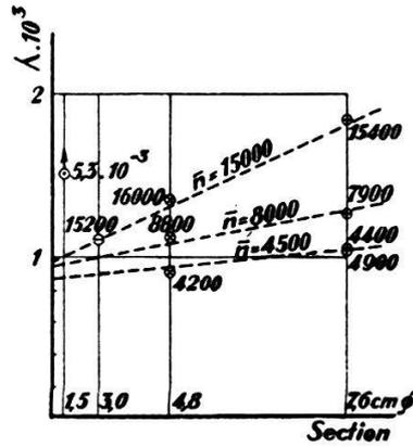
FIG. 33b. — Ions positifs. Extrapolation par sections décroissantes.
