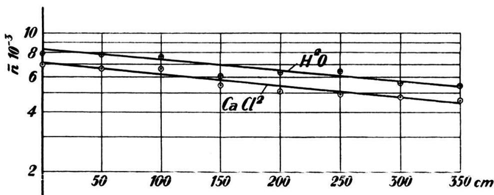
FIG. 36. — Influence de la tension de vapeur d'eau sur la déperdition.
