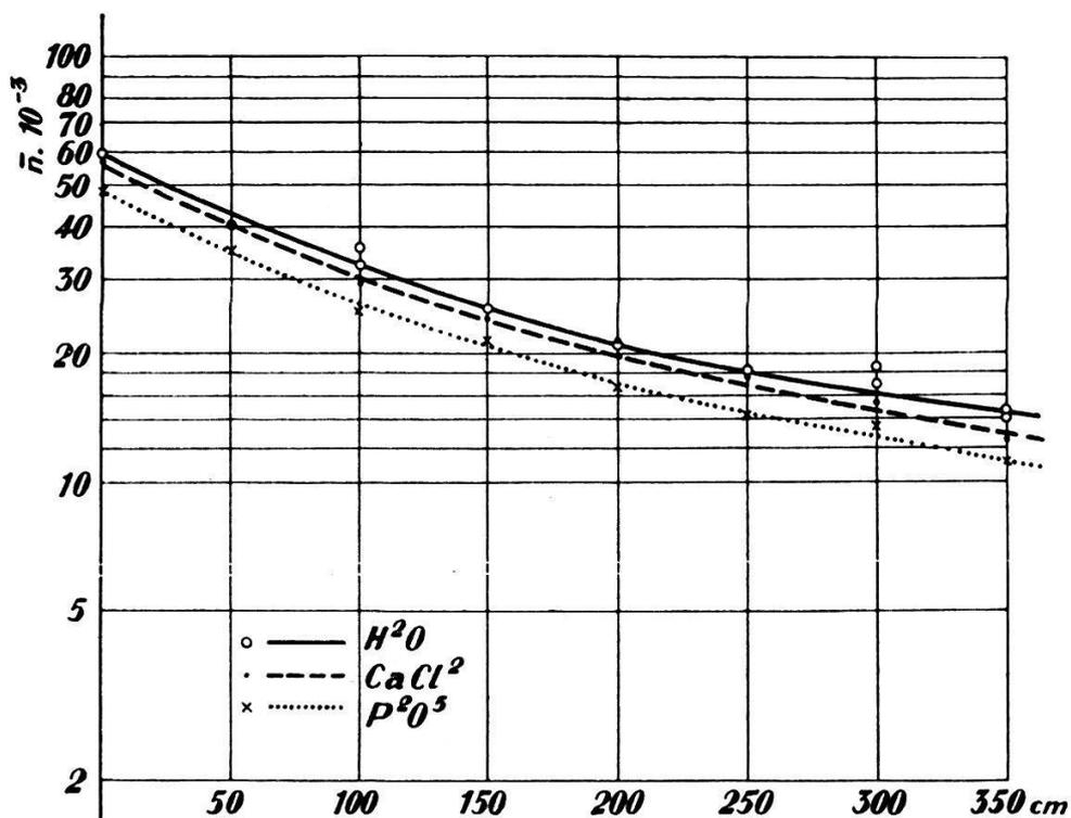
FIG. 29. — Affaiblissement d'un écoulement unipolaire négatif.
