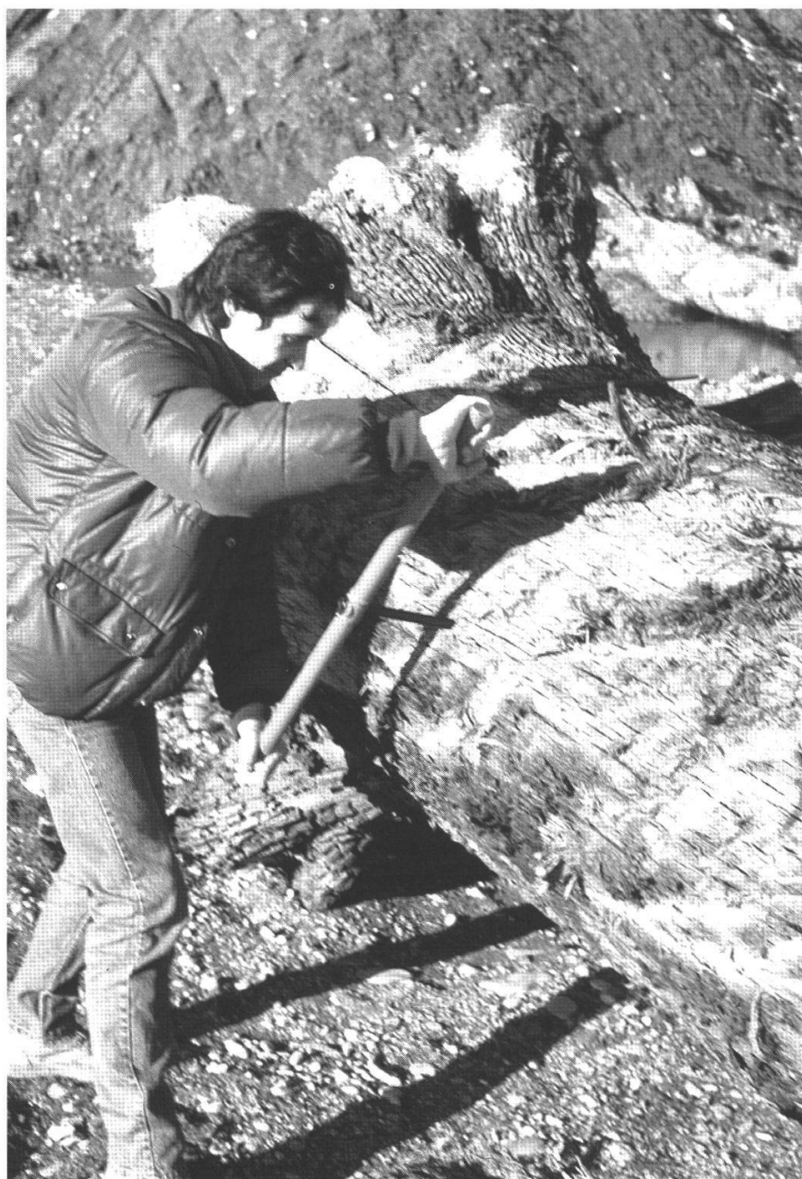
Figure 3.—Carottage d'un tronc de chêne à l'aide de la sonde finlandaise de 12 mm. Sur les contreforts des racines, on distingue l'aubier craquelé. Celui-ci est déjà manquant à l'emplacement du carottage.
