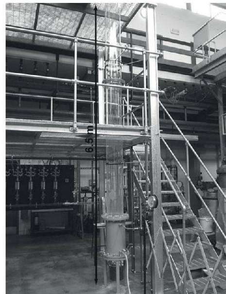
Figure 2.–La colonne verticale pour l'étude de l'écoulement des bulles de gaz dans les magmas basaltiques.
