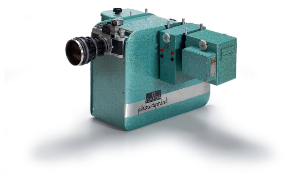
1 Omega Photosprint, appareil photofinish avec boîtier Alpa, 1963 (Archives Omega, Bienne).
