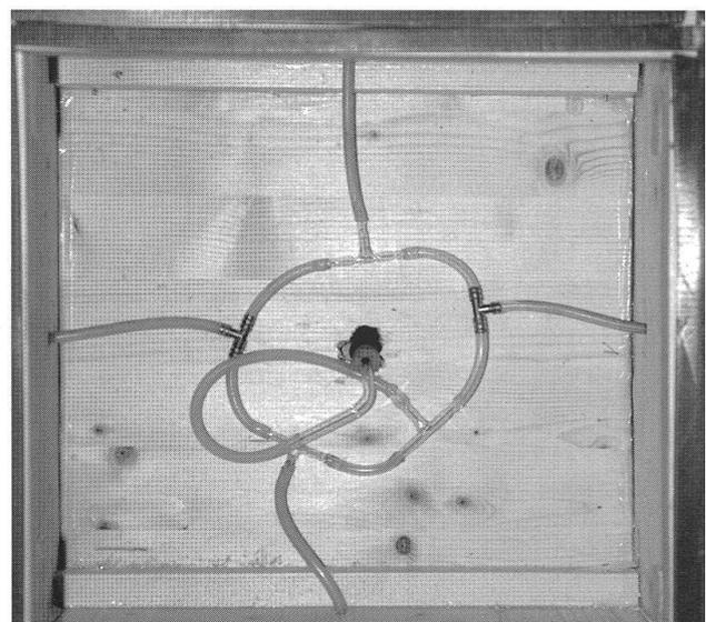
**Abb. 9:** Schläuche der Zeckenfalle, durch die das CO<sub>2</sub> nach aussen strömt.
