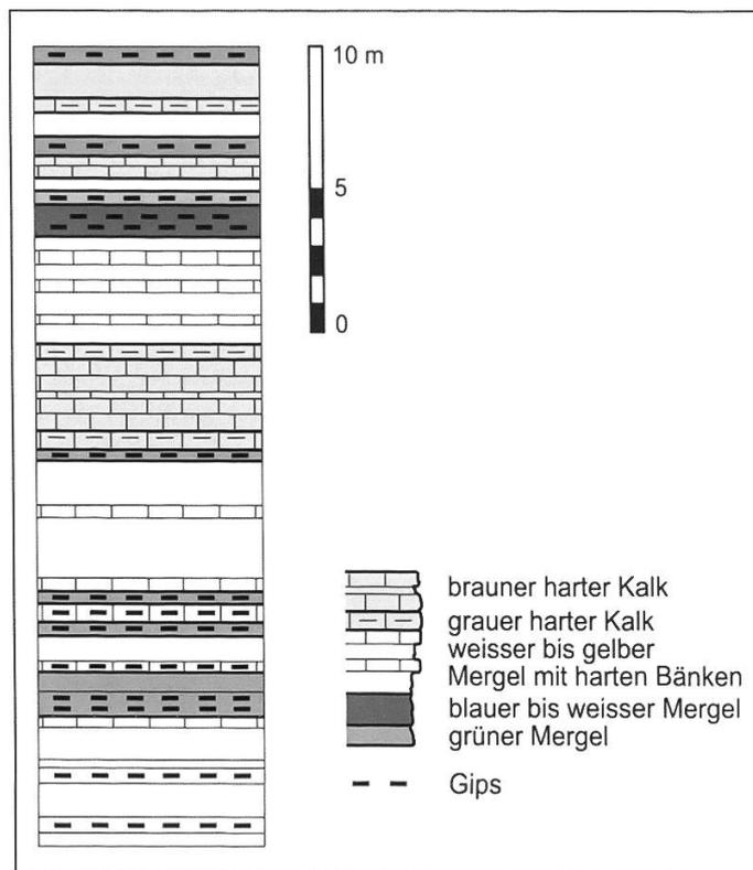
**Abb. 7:** Geologisches Profil der Tüllinger Süsswaserkalk (Baugrube des Kraftwerks Birsfelden): In verschiedenen Lagen wurden bis 20 cm grosse Gipskristalle gefunden (Quelle: Baugrundarchiv Basel-Stadt und Aegerter & Bosshardt AG, Basel).
