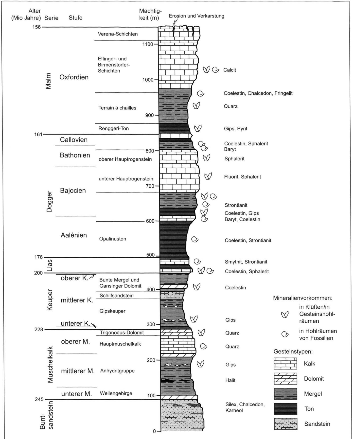
**Abb. 2:** Schichtgebundene Mineralvorkommen des Mesozoikums in der Umgebung Basels (basierend auf Holenweg 1969). Die idealisierte Schichtabfolge des Baselbieterjuras ist aus Fischer (1969), Hauber (1978) und Müller et al. (1984) zusammengefasst. Die geologische Zeitskala basiert auf Gradstein et al. (2004).
