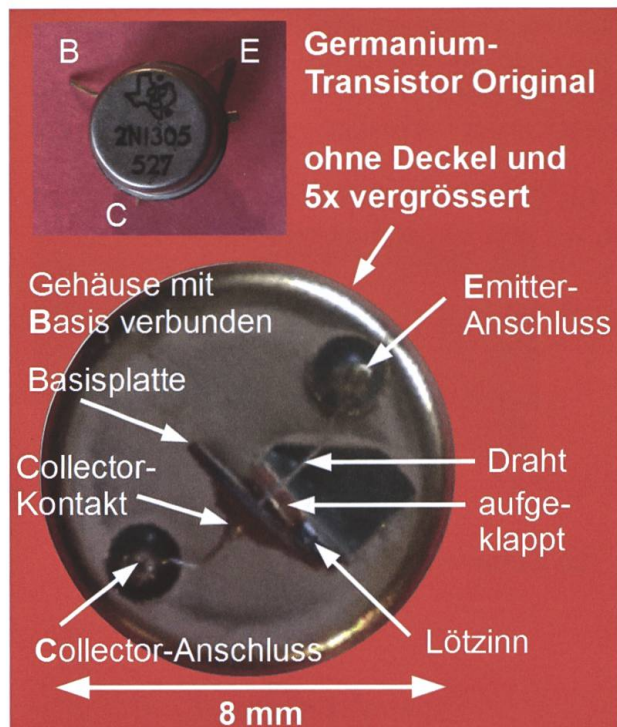
Abb. 11: Germanium Bipolartransistor 2N1305 in Metallbecher-Gehäuse der 1960er-Jahre. Originalansicht und fünffache Vergrößerung nach Entfernung des Deckels. Der trapezförmige Ausschnitt der Bodenplatte wurde senkrecht nach oben gebogen und an die Transistoren-Basisplatte gelötet. So wurde die Verlustleistung des Transistors an sein Gehäuse abgeführt. Ins Zentrum der Basisplatte wurde ein Loch gebohrt und dessen Rand becherförmig ausgestülpt (vgl. Abb. 12). Die Anschlussdrähte an Emitter und Collector sind knapp erkennbar. Der Durchmesser des Gehäuses misst 8 mm (Bild: Fritz Gassmann).
