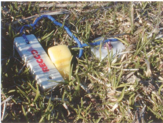
Abb. 3: Temperatur-Logger mit Recco-Sender und Häring. Rechts ist der Temperatur-Logger zu sehen. Er ist durch eine Schnur mit einem Häring und einem Recco-Sender verbunden, damit er nach der Schneeschmelze sicherlich wieder gefunden werden kann. (Foto Priska Hiller)
